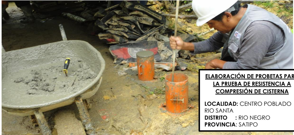
**ELABORACIÓN DE PROBETAS PARA LA PRUEBA DE RESISTENCIA A COMPRESIÓN DE CISTERNA**
